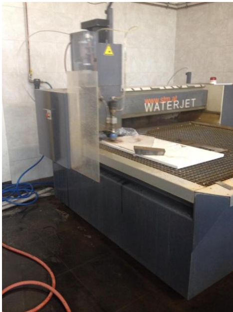
Foto links: Schneiden der Schrift mit dem Waterjet
